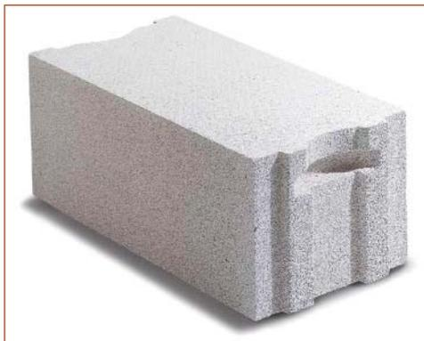
Le béton cellulaire est un matériau constitué d'eau, de sable, de chaux et d'adjuvant (ciment et poudre d'aluminium). Il se présente sous forme de blocs pleins très poreux et est mis en œuvre avec un mortier-colle particulier.
