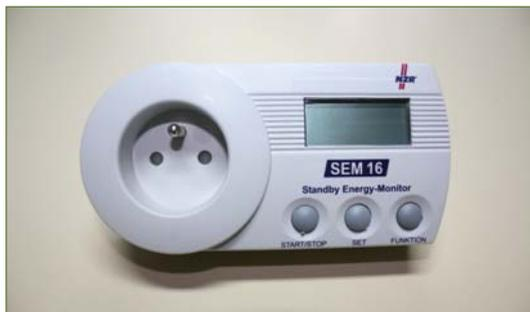
Ce produit qui permet de contrôler les consommations électriques en temps réel sur une prise murale est intéressant pour détecter les dysfonctionnements et les surconsommations ainsi que pour sensibiliser les usagers.
