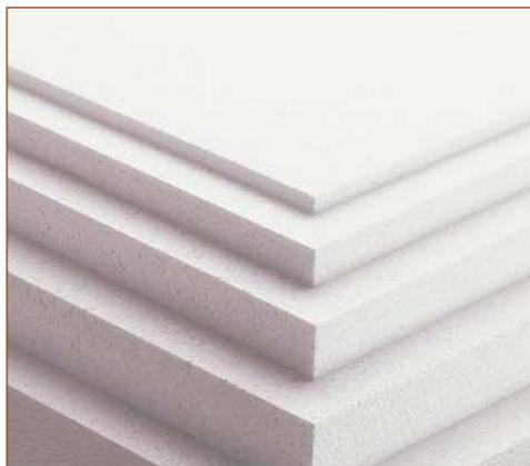
Le polystyrène expansé se présente sous forme de panneaux fixés sur les chevrons sous la toiture. Il faut bien veiller à laisser une lame d'air de 1 à 2 cm entre les panneaux et la tôle, sans quoi le polystyrène pourrait fondre et perdre ses qualités isolantes.
