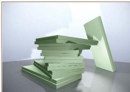
Le polystyrène extrudé se présente sous forme de panneaux. Il peut être posé sous rampant ou sur une toiture terrasse. Lorsqu'il est posé sous rampant, il faut bien veiller à laisser une lame d'air de 1 à 2 cm entre le panneau et la tôle, sans quoi le polystyrène pourrait fondre et perdre ses qualités isolantes.
